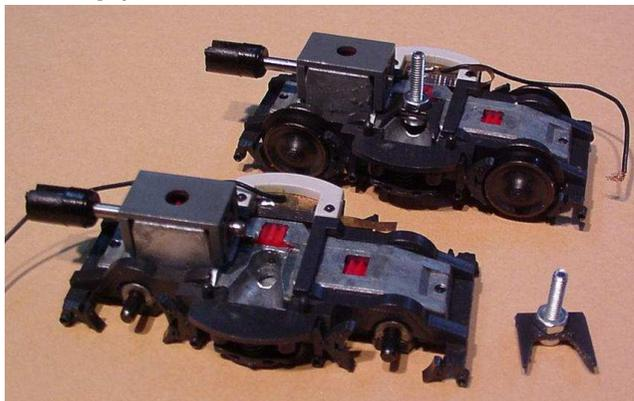
et empêcher qu'il se desserre. Là, vous vous rendez compte que un les roues touchent quasiment le châssis, il faut donc mettre une cale en plasticarte de 0.5 mm d'épaisseur de chaque côté de la vis (coller le plasticarte au chloro sur, enfin, sous le châssis) et que deux, les pièces en plastique blanc du bogie Roco et qui ont une forme cir-
