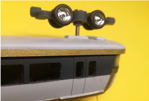
Coller vos vitres à l'intérieur de la caisse, coller avec de la résine pour imprimante 3D avec une torche UV. Acheter de la résine chez amazon, 500 ml, transparente, 400 nanomètres, elegoo, 17 teuro environ. Acheter une mini torche LED UV, 6.00 zeuro environ. Acheter en pharmacie une petite bouteille de 30ml en verre, et entourer là au ruban adhésif noir (chatterton) afin que la lumière ne passe pas. Remplir de résine votre petite bouteille.
