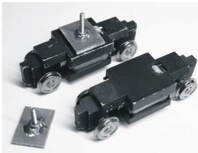
Coller au milieu, bien au centre, la plaquette de circuit imprimé avec la vis déjà soudée, sur le bogie moteur, avec de la cyano.
