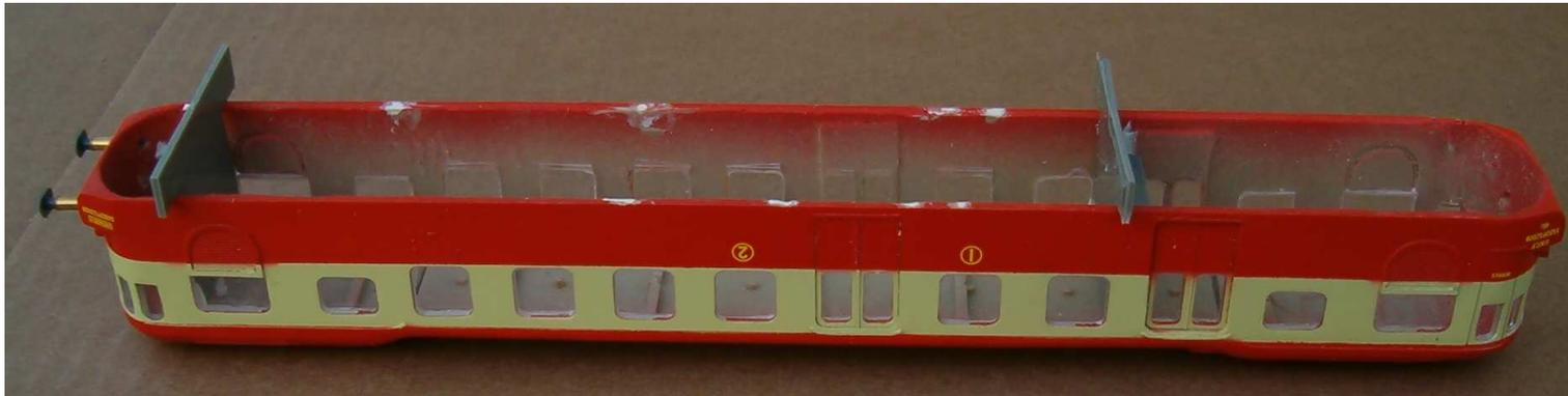
Bien repérer l'endroit du collage des cales. Les coller au sintofer, celui vendu en tube, pas en boîte, et c'est le tube rouge qu'il faut prendre. Mettre en place les LED avant les cales, pas comme sur la photo. D'autres parts, il est nécessaire pour coller les cales de fraiser les renforts dans le fond de la toiture là où les deux cales vont être collés. Il n'y a aucun danger pour la structure de la caisse, ces renforts sont là pour le modèle maître moulé.
