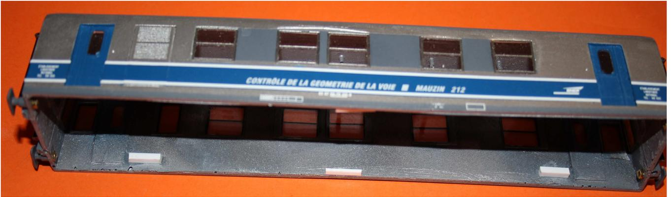
Pour la fixation de la caisse au châssis, coller des cales comme sur la photo en plasticarte Evergreen, les deux à chaque bout pour empêcher le châssis de tomber dans le fond de la caisse, et la distance est de 2.5 mm entre le bas de caisse et le bas de la cale, et celles au milieu pour empêcher le châssis de tomber par terre quand vous attrapez votre Mauzin. Il suffit d'écarter la caisse pour enlever le châssis.
