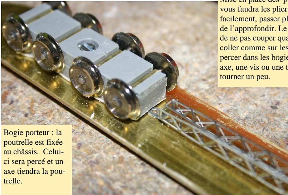
Bogie porteur : la poutrelle est fixée au châssis. Celui-ci sera percé et un axe tiendra la poutrelle.
